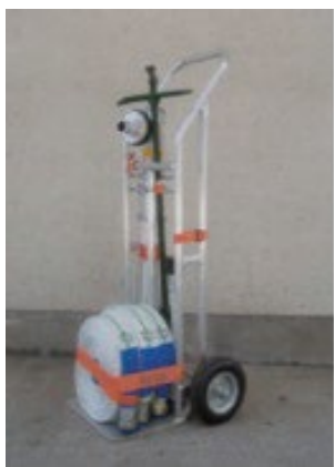
スタンドパイプ式初期消火器具一式
