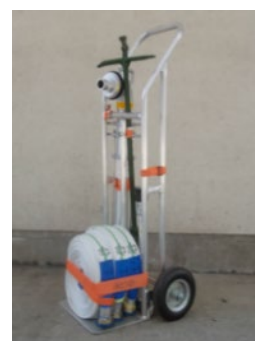
スタンドパイプ式 初期消火器具(可搬式)
